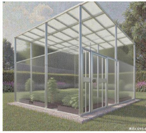
附图 4 遮雨大棚示意图 (4*5 米, 高 3.5 米)
